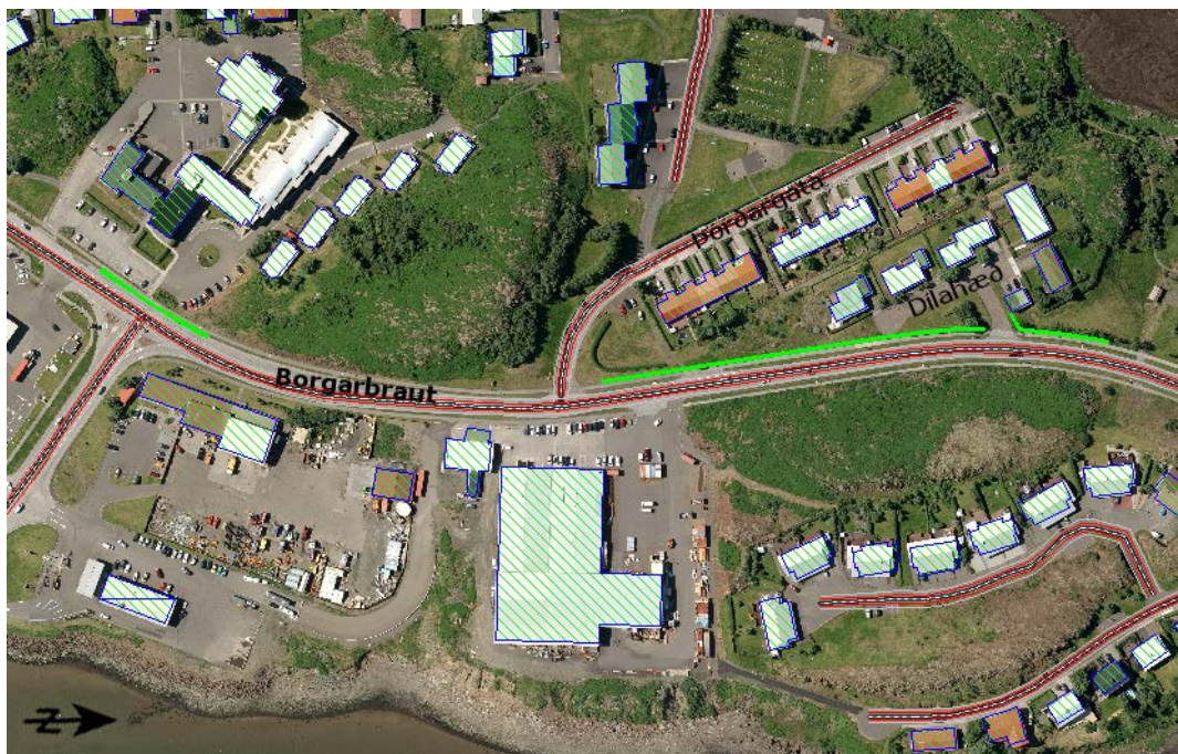
Mynd 1 Yfirlitsmynd úr líkani sem sýnir staðsetningu hljóðveggja (grænar línur) meðfram Borgarbraut.
